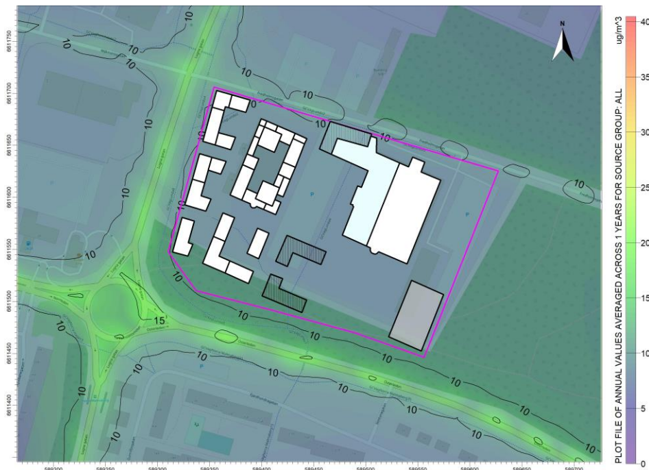
Figur 5. Framtida scenario 2040 , beräknade halter av kvävedioxid som årsmedelvärden. Planområdet markeras med lila linje.
